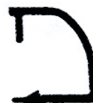
231 M Contravidrio curvo 15mm Peso 0.179 kg/m
