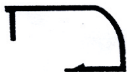
230 M Contravidrio curvo 29mm Peso 0.243 kg/m
