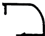
232 M Contravidrio curvo 22mm Peso 0.205 kg/m
